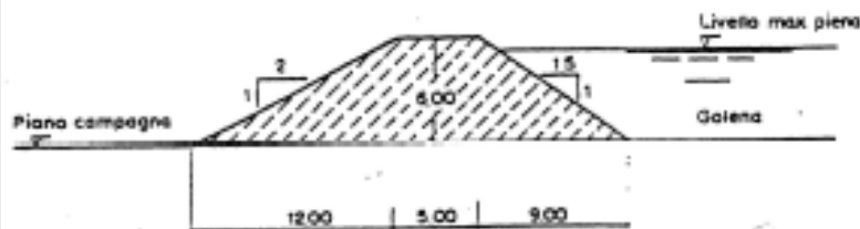
c) Argine con banca, sottobanca, pie di banca e petto, antipetto e parapetto
